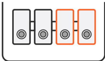
**3. Branchez les fils noir et gris de l'Actionneur chaudière sur les connecteurs de l'entrée thermostat (LS-LR, TA ou COM-NO) de la chaudière. Le sens n'a pas d'importance (pas de polarité).**
