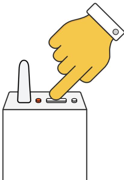
N'oubliez pas d'appuyer de nouveau sur le bouton afin d'éteindre votre chaudière (la diode de l'Actionneur doit également s'éteindre).
